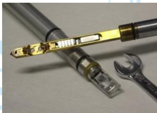
شکل ۲- نگهدارنده نمونه در میکروسکوپ الکترونی عبوری [۱۱].
