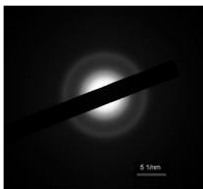
شکل ۴- الگوی پراش الکترونی از یک لایه نازک SiN آمورف [۵].
